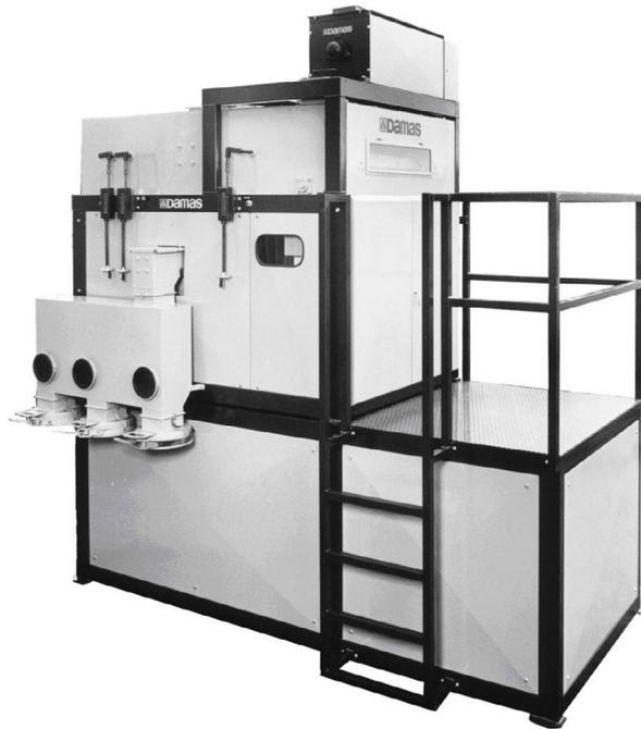
Die Combi V ist eine komplette Saatgutreinigungsanlage, bestehend aus Entgranner, Reinigungsmaschine mit Sieb- und Luftsystemen sowie Kurzkorntrieur.
